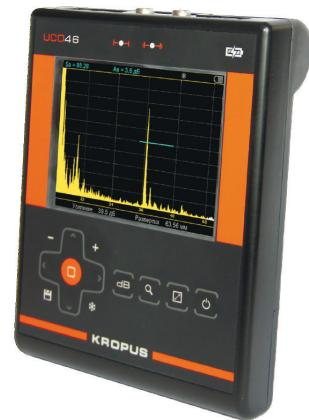
Ударопрочный корпус из ABS пластика с классом защиты по IP 65 и встроенный мощный Li-Pol аккумулятор позволили сделать массу прибора менее 0.9кг, а возможность смены цвета позволяет с комфортом работать на солнечном свете.
