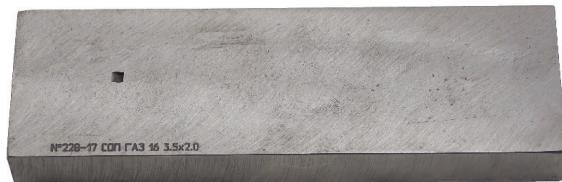
Стандартные образцы для оценки качества и характеристик ультразвуковой аппаратуры с фазированными решетками. Выполняется согласно различным стандартам (в т.ч. ASTM E2491) из различных материалов: конструкционной углеродистой качественной стали, нержавеющей стали или алюминия.
