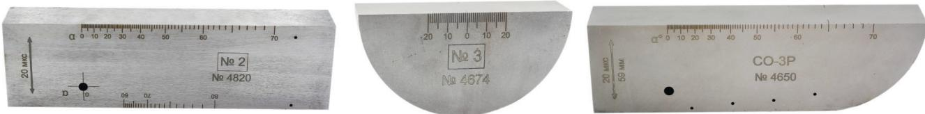
Стандартные образцы предприятия (СОП) с контрольными отражателями в виде зарубок для настройки чувствительности при дефектоскопии сварных соединений. Выпускаются как СОП для плоских объектов контроля, так и для контроля стыковых сварных соединений труб и контроля гибов трубопроводов.
