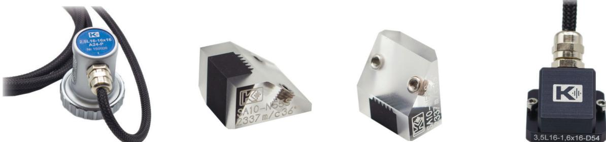
**Преобразователи и призмы TOFD** – предназначены в основном для контроля кольцевых и продольных сварных швов. В данных преобразователях основным способом обнаружения дефектов является использование продольных волн. Призмы изготовлены из очень стойкого к износу материала Rexolite. По умолчанию в призмы устанавливаются штуцеры для подачи контактной жидкости, что позволяет использовать их со всеми стандартными типами сканеров.
