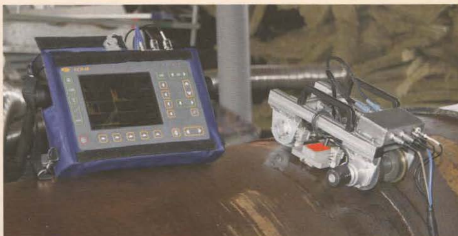
Рис. 1. Ультразвуковой восьмиканальный сканер-дефектоскоп УСД-60-8К
